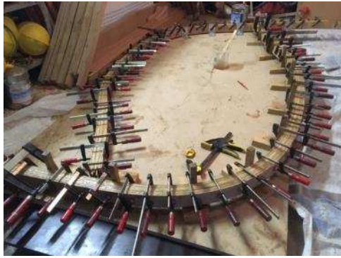
Cintrage des 43 membrures
