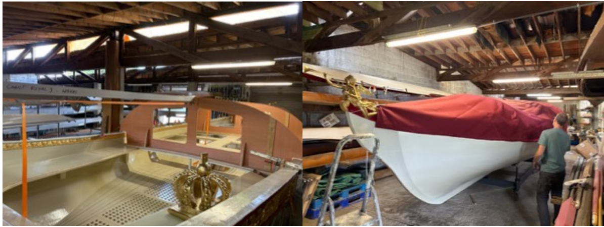
La structure de soutien de la bache et réalisation de la bache par Outsider Sails
