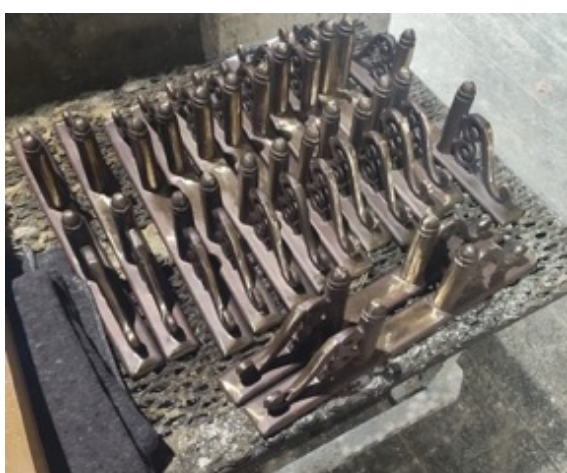
Réalisation des portières de nage en bronze et finition des avirons
